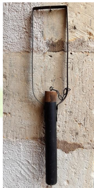
Appareil dans lequel on mettait une plaquette pour souffrer les barriques. Coll.E.
